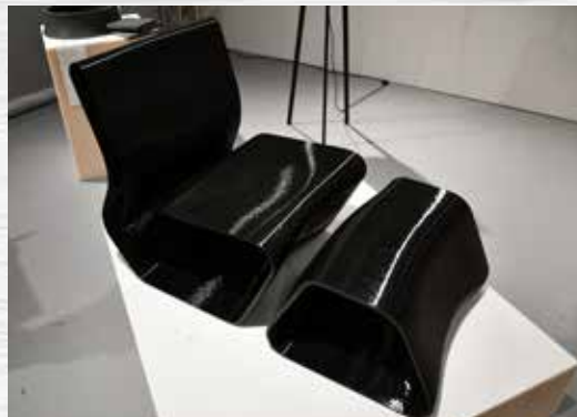
Ein 3D-Druck zum Sitzen: Der Sessel wurde mithilfe eines Kuka-Roboters erstellt. Die typischen Rillen in der gedruckten Fläche erzeugen interessante Lichtreflexionen.
