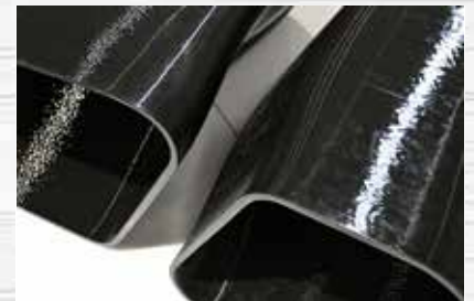
Ein 3D-Druck zum Sitzen: Der Sessel wurde mithilfe eines Kuka-Roboters erstellt. Die typischen Rillen in der gedruckten Fläche erzeugen interessante Lichtreflexionen.
